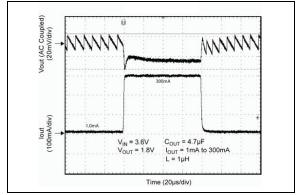
**FIGURE 2-24:** Load Transient.
