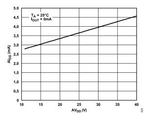
Figure 26. AI<sub>DD</sub> vs. AV<sub>DD</sub>
